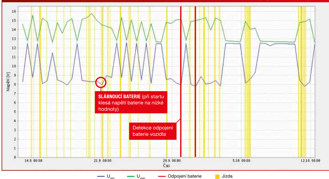
Graf napětí na baterii konkrétního vozidla v době, kdy došlo k jejímu odpojení
